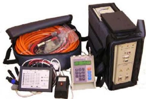
Мосты переменного тока высоковольтные автоматические СА7100 (далее – Мосты) предназначены для измерений тангенса угла диэлектрических потерь (далее – тангенс угла потерь) и электрической емкости (далее – емкость), напряжения и частоты переменного тока, сопротивления изоляции постоянному току (далее – сопротивления).
